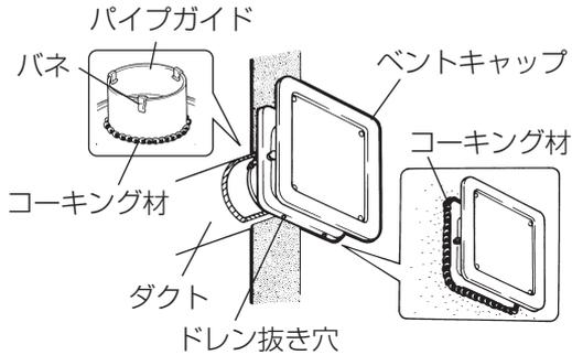
1. ベントキャップを据付ける前に、市販のコーキング材で図のようにパイプガイドに防水処置を施す。
