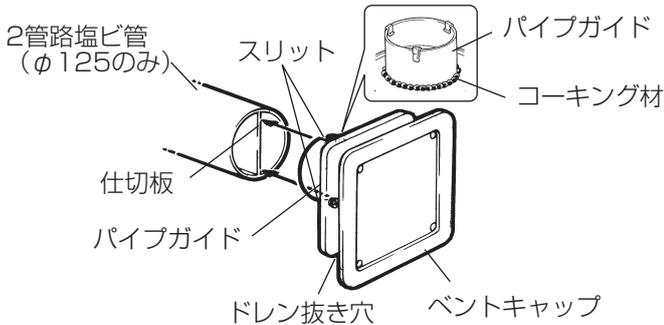
1. ベントキャップを据付ける前に、市販のコーキング材で図のようにパイプガイドに防水処置を施す。
