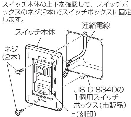
3 スイッチパネル、風量操作板を取り付ける。
