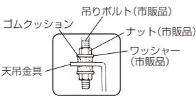
本体が水平になるように天吊金具を吊りボルトに据付け、ナットがゆるまないようワッシャー・ナットにて確実に固定する。
