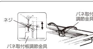
パネ取付板調節金具のネジ（左右）をゆるめ、パネ取付板を調節分だけスライドさせて、ネジを締め付け固定する。
