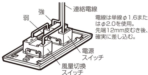
電線は単線φ1.6またはφ2.0を使用。先端12mm皮むき後、確実に差し込む。
