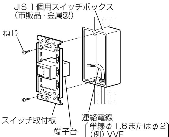
あらかじめ用意されている連絡電線を結線図に従ってコントロールスイッチの端子台に接続し、1個用スイッチボックスに取付ける。
