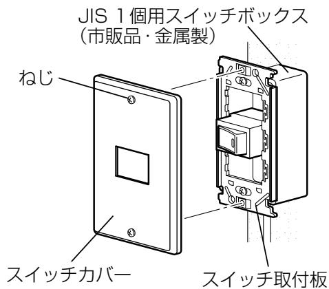
スイッチカバーの保護シートをはがし、スイッチカバーをスイッチ取付板に取付ける。
