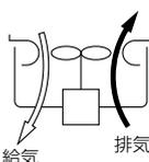
上方向または下方向へ風を送る場合は羽根上向き姿勢で据付け、排気または給気で使用してください。
