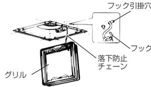
パネを長穴に差し込む前に、落下防止チェーンのフックを端子カバー近くのフック引掛穴に引掛ける。
