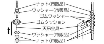
本体が水平になるように天吊金具を吊りボルトに据付け、ナットがゆるまないようワッシャー・ナットにて確実に固定する。
