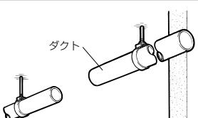
壁排気穴から本体のダクト接続口および副吸込位置（VD-15ZFVC6、VD-18ZFVC6）までダクト配管する。
