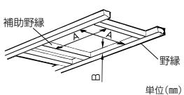
内寸がA寸法、高さがB寸法以下になるよう天井の野縁と補助野縁で据付枠を組む。（野縁高さをB寸法以上で据付けると、シャッター開閉不良・異常音の原因となります）
