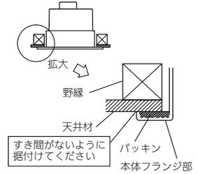
以下、①野縁に本体フランジを据付ける方法を例として記載しています。②天井材の下に本体フランジを据付ける方法については、野縁組立後に天井材を張り同様の手順で据付けてください。
