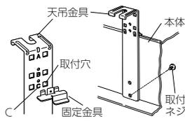
本体が水平になるように天吊金具を吊りボルトに据付け、ナットがゆるまないようワッシャー・ナットにて確実に固定する。
