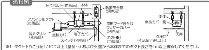
※1 ダクト下りこう配1/100以上（壁側へ）および外壁から本体までのダクト長さを1m以上確保してください。
