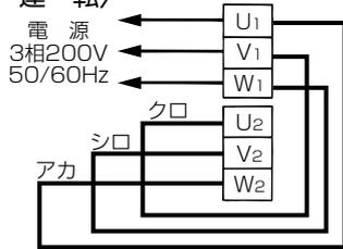
※U<sub>1</sub>, V<sub>1</sub>, W<sub>1</sub>に電源線を接続してください。
