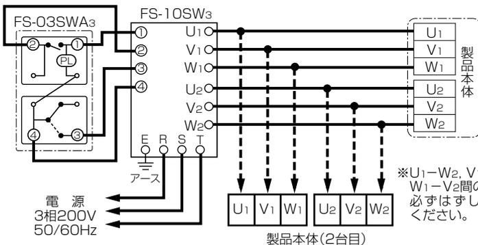
※U<sub>1</sub>-W<sub>2</sub>, V<sub>1</sub>-U<sub>2</sub>, W<sub>1</sub>-V<sub>2</sub>間の渡り線を必ずはずしてご使用ください。
