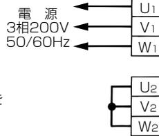
※U<sub>1</sub>-W<sub>2</sub>, V<sub>1</sub>-U<sub>2</sub>, W<sub>1</sub>-V<sub>2</sub>間のリードのU<sub>1</sub>, V<sub>1</sub>, W<sub>1</sub>側をはずしU<sub>2</sub>, V<sub>2</sub>, W<sub>2</sub>を短絡させます。その後、U<sub>1</sub>, V<sub>1</sub>, W<sub>1</sub>に電源線を接続してください。
