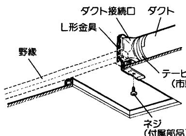
ダクト接続口を取付けてダクト配管を行います。
