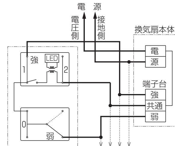
換気扇の据付説明書がない場合は必ず換気扇本体の結線銘板に記載してある制御機種（リレー内蔵機種など）を確認し上記の中から該当する機種の結線をおこなってください。
