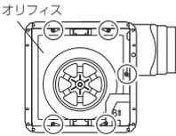
本体を水平にし、天吊金具を吊りボルトに据付ける。
