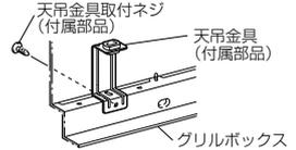
**2 本体を水平にし、天吊金具を吊りボルトに据付ける。**
