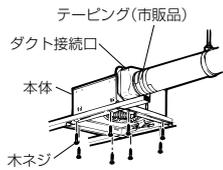
野縁の強度が十分でない場合は同梱の天吊金具を併用してください。
