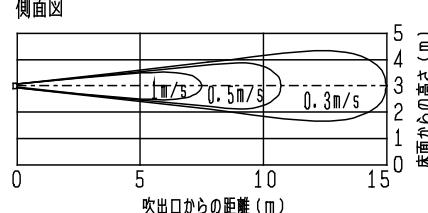
※図中の風速分布は室内温度差、外風、空調機などによる外乱がない自由空間における測定値です。
