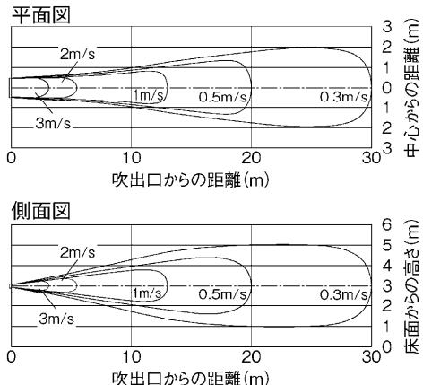
※ 図中の風速分布は室内温度差、外風、空調機などによる外乱がない自由空間における測定値です。
