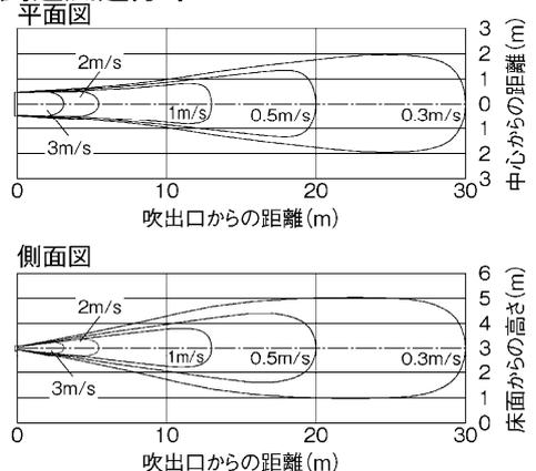
※ 図中の風速分布は室内温度差、外風、空調機などによる外乱がない自由空間における測定値です。
