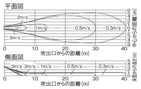
※図中の風速分布は室内温度差、外風、空調機などに よる外乱がない自由空間における測定値です。
