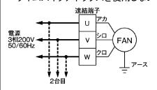
※ 図中太線及び破線部分は電 気工事の資格を有する方に て施工してください。
