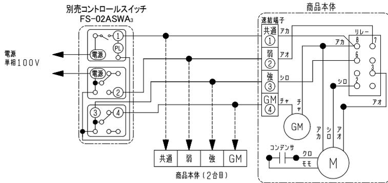
※図中太線および破線部分は電気工事の資格を有する方にて施工してください。
