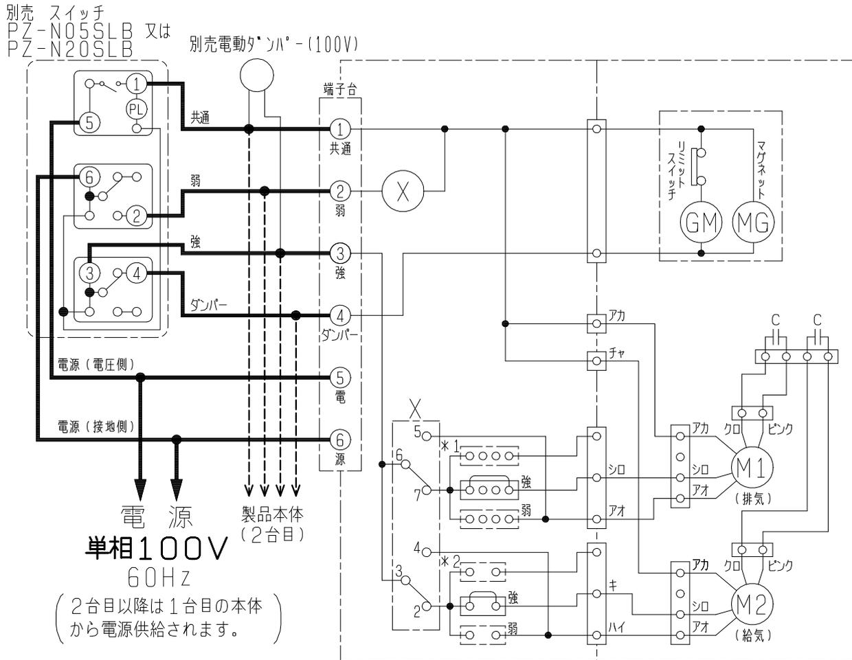
\*1 排気側マルチ換気モード\* 設定コネクタ (工場出荷時は強になっています)
