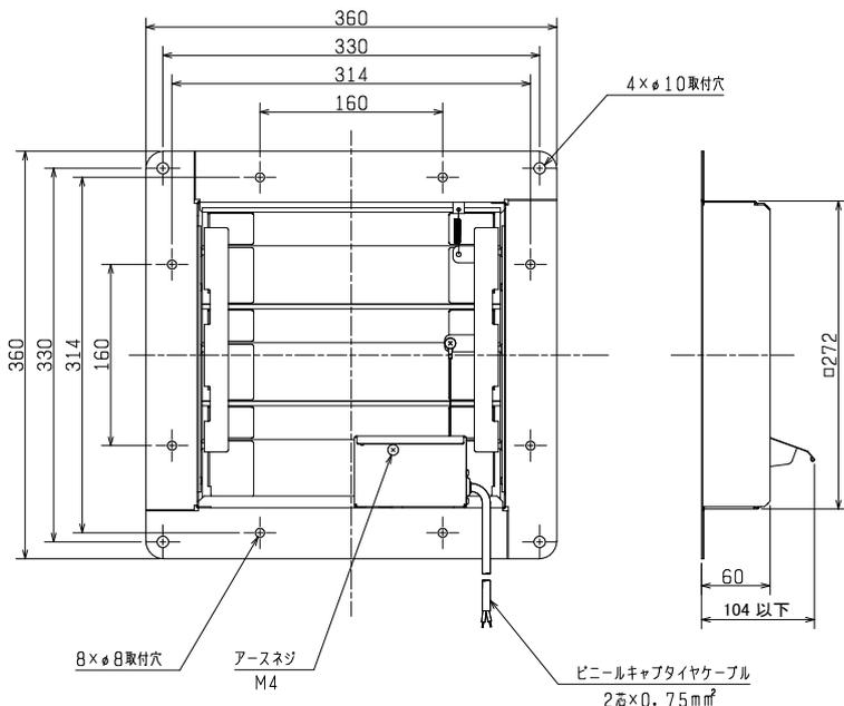
※電源コードは有圧換気扇と共締めした時に有圧換気扇の枠から約1m出ます。(有圧換気扇の枠にコード取出し用ノックアウト穴があります。)
