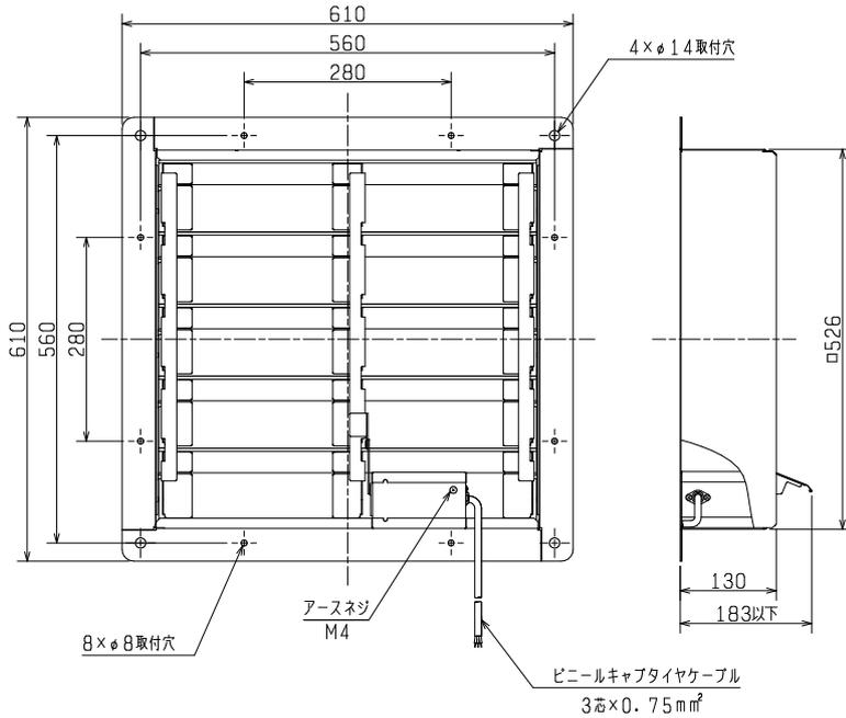
※電源コードは有圧換気扇と共締めした時に有圧換気扇の枠から約1m出ます。(有圧換気扇の枠にコード取出し用ノックアウト穴があります。)
