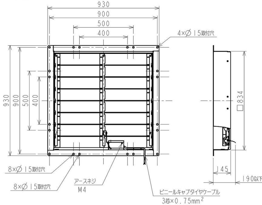
※電源コードは有圧換気扇と共締めした時に有圧換気扇の枠から約1m出ます。（有圧換気扇の枠にコード取出し用のノックアウト穴があります。）
