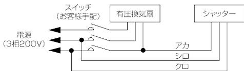
※電源コード3芯のシャッターは切時もモーター作動で閉となります。したがってシャッターから出ている3線は上図のように配線してください。
