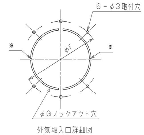
外気取入口は※印部のみ切断し、円盤を水平方向に回転させ取入量を調整してください。
