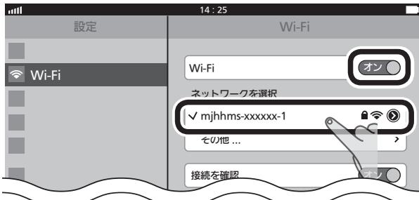
ネットワーク(SSID)は、情報収集ユニットの銘板に表示されているSSIDを選択してください。
