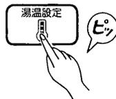
スイッチを押すごとに湯温設定表示が“高”→“中”→“低”→“自動節約”→“高”→…と切り換わります。
