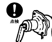
点検しないとタンクが破損したり、逃し弁から水漏れたりすることがあります。
