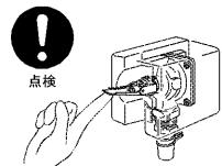
点検しないとタンクや配管が破損したり、逃し弁から水漏れしたりすることがあります。
