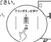
**△警告** 漏電遮断器の動作を確認する(感電の原因)
