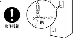
異常(こげ臭いなど)時は、漏電遮断器の電源レバー(P6)を下げて電源を「切」にし、お買い上げの販売店または「三菱電機修理窓口」へ連絡する
