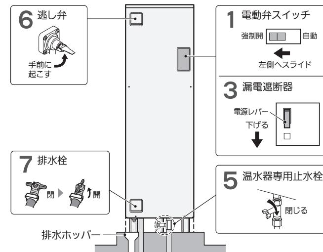
**1 電動弁スイッチを「強制開」にする**
