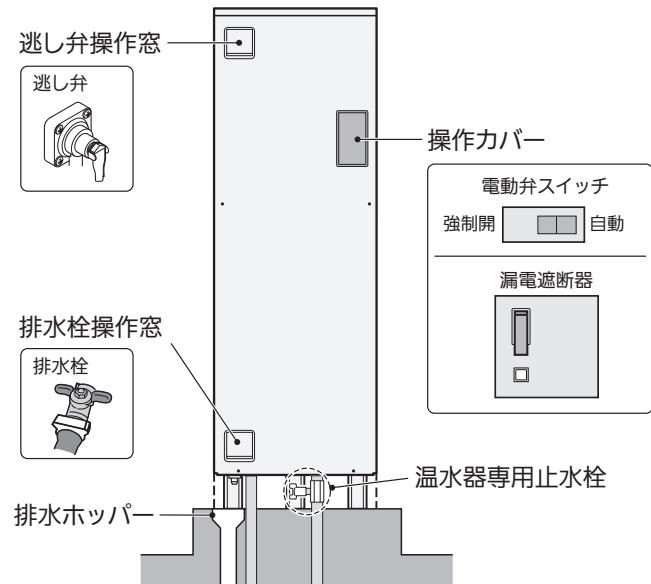
**お願い** ●温水器専用止水栓が図の位置に取り付けられていない場合は、据付工事店へ取付位置を確認してください。
