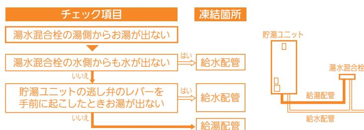
※外気温が低く、給水・給湯配管凍結のおそれがある場合は、少量の水を流して凍結防止を行う「水」設定機能があります。(P34)
