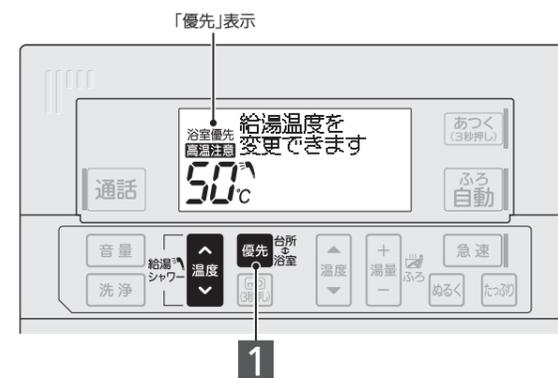
※浴室リモコンか台所リモコンのどちらか一方で給湯温度変更をできるようにすることを、そのリモコンに「優先権」を与えと呼んでいます。例えば、浴室でシャワーを浴びているときに台所リモコンで蛇口のお湯を熱くすると、熱いお湯が出る可能性があります。この場合は、台所リモコンでの温度変更を禁止させるため、浴室リモコンに「優先権」を与えてください。
