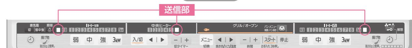
レンジフード連動システムは、上面操作部の送信部 (3ヵ所) から発信した赤外線信号を、換気扇が受信して動作します。送信部・受信部が汚れたり、信号がさえぎられたりすると、換気扇が動作しない場合があります。
