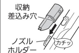
はずすときは、サッシノズルを引き抜く
