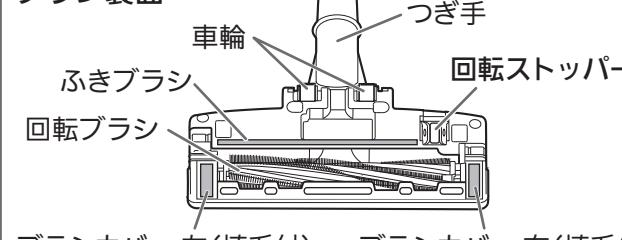
「回転ストッパー」は、パワーブラシを床面から浮かせると、安全のために回転ブラシの回転を止める機構です。
