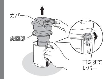
旋回部をはずしたときは、必ずゴミをすててください。 〔クリーンカートリッジにゴミが付着する原因〕
