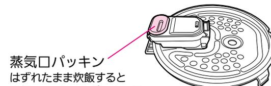
蒸気口パッキンがはずれた場合は、押し込む
