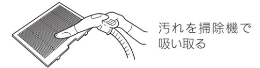
ブラシ付ノズルは使わないでください。フィルター破損の原因になります。
