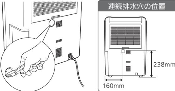
本体背面にある連続排水穴の固定リブ(3箇所)をニッパーなどでカットし、内部に落ちないように取除く(切断部だけがをしないよう注意してください)
