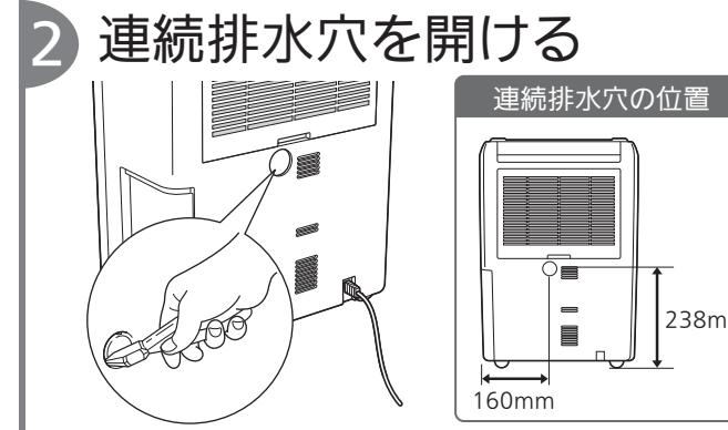
本体背面にある連続排水穴の固定リブ(3箇所)をニッパーなどでカットし、内部に落ちないように取除く(切断部だけがをしないよう注意してください)
