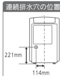
本体背面にある連続排水穴の固定リップ（3箇所）をニッパーなどでカットし、内部に落ちないように取除く（切断部だけがしないよう注意してください）
