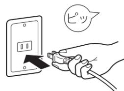
電源プラグをコンセントに差込むと、ルーバーが自動で停止位置に戻ります。
