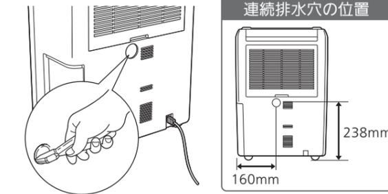
本体背面にある連続排水穴の固定リブ（3箇所）をニッパーなどでカットし、内部に落ちないように取除く
