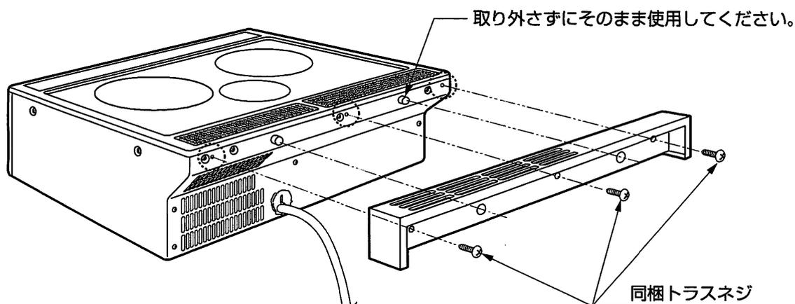
本体○印のネジ穴に位置を合わせてネジ締めする。(3ヶ所)
