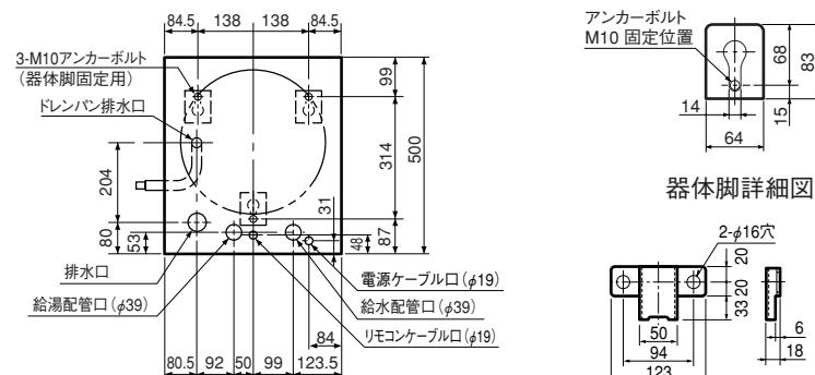
配管、アンカーボルト位置上面透視図
