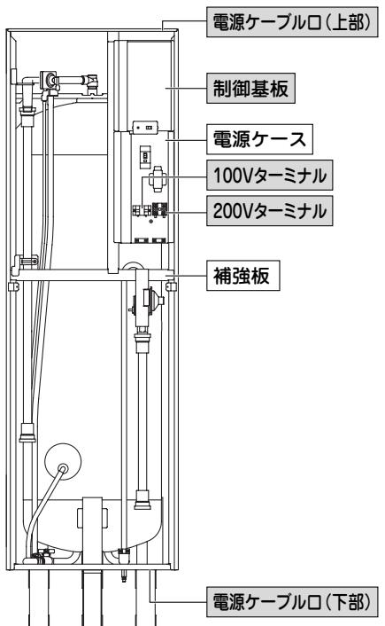
【お願い】・電源線は、上部または下部から配線できます。上部から配線する場合は、電源ケーブル口に切り込み(図)を入れてください。また、電源線は電源ケースの裏側を通してください。下部から配線する場合、電源線は補強板の裏側を通してください。
