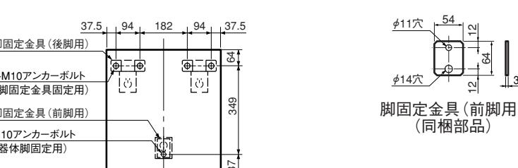
脚固定金具使用時アンカーボルト位置上面透視図
