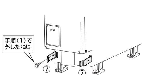
(3) 前面支持板1(⑤⑥)、後面支持板(⑧)を給湯機に取り付ける
