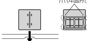
排気カバー受け、取り付け方のコツ最初に左右どちらかの爪を引掛け、イラストのように曲げながら逆側も取り付ける
