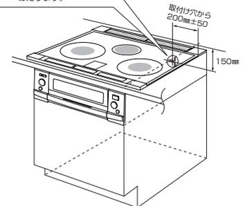
上面ガラス幅600mmタイプ、ワイド750mmタイプはガラス向かい右側先端より150mm
