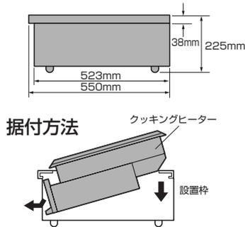
(\*トッププレート幅750mmタイプ 設置枠は「CS-Z75 WAKU」枠幅750mmです。)
