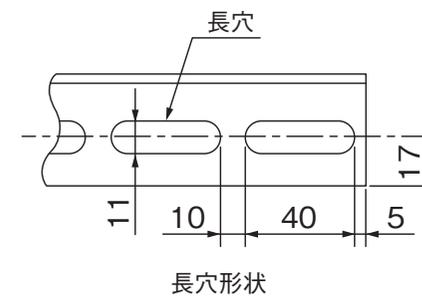
上部固定アングルセット(壁面固定用) GZ-A2C
