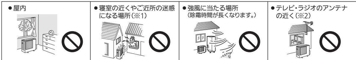
※1.ヒートポンプユニットはわき上げ中及び凍結防止運転中に運転音、振動が発生します。据付場所の状態、運転音は大きくなります。また、わき上げ中は冷風がでますので、寝室の近くやご近所の迷惑になる場所への据え付けは避けてください。また、各地区の騒音規制等に関する条例にしたがって設置してください。
