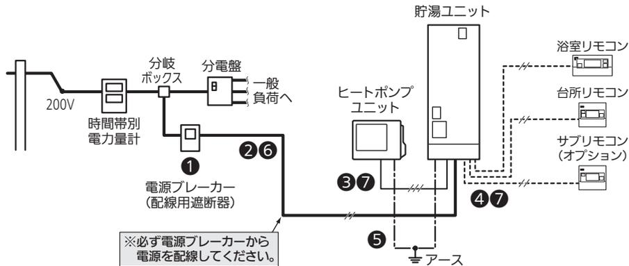
※必ず電源ブレーカーから電源を配線してください。
