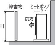
所要スペース(D1及びD2)は、障害物の高さ(H)によって変わります。風向ガイドを取り付ける場合は、下表を参照ください。ただし、設置条件によっては運転音が上がることがあります。
